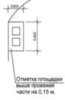
Фрагмент 2 Устройство площадки под мусорные контейнеры
